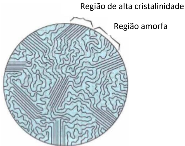
Microestrutura de um polímero semi-cristalino apresentando regiões cristalinas e amorfas
